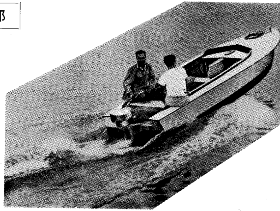
↑ 生研試作アルミ艇 昭和 27 年船外機艇として完成, 29 年夏帆装をほどこした全アルミニウム製高速艇で, わが国最初のものである。ヨットにも使用できる。(安藤研究室)
