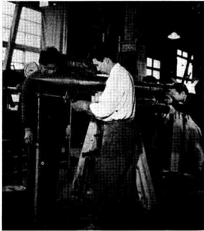
第 6 図 エンジン部の曲げ試験
