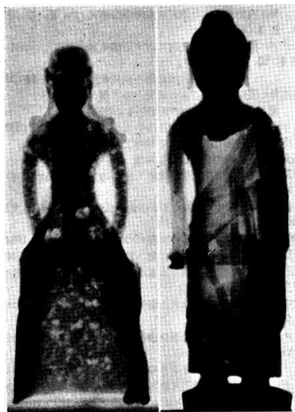
左: 材質が悪く、鑄込みに生じた気泡を多く含んでいる。 右: 頭から上部は別に鑄造してはめこんでいることが分る。
