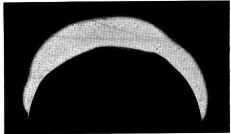
写真1 ピストンリングのオートラジオグラフィ(1), X線フィルム使用
