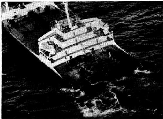
第 1 図 大西洋で真二つに折れたスーパータンカー Worldconcord
