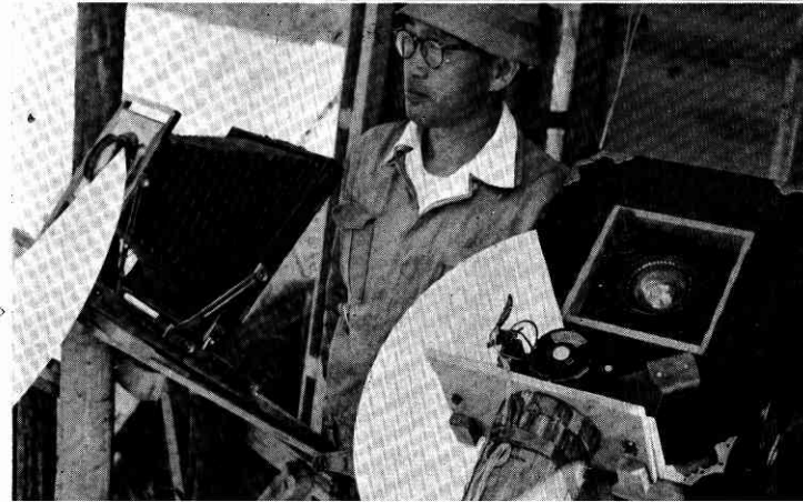
⇨ 南観測点における固定カメラ群 手前が 200mm Topogon レン ズ付カメラ, 向う側 250mm Tessar レンズ付カメラ
