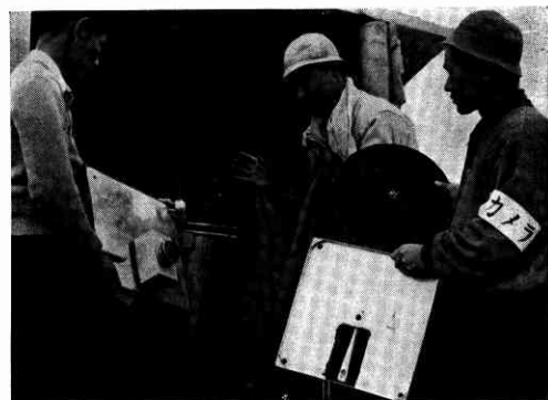
⇒ ロケット撮影用として特に設計、製作されたセクタ・フレーム・カメラ (次頁参照) フィルム装填中のところ。
