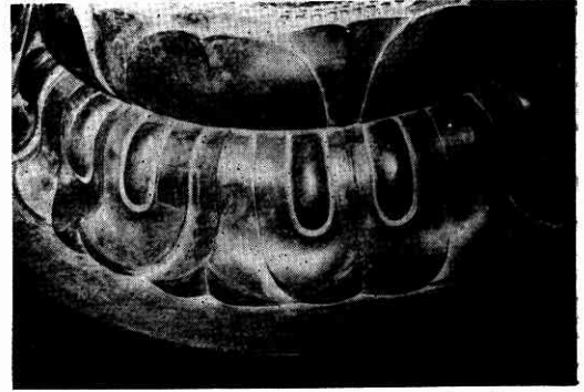
(C) 蓮座 型もち(一寸四方のブロック)を用いる。 第3図(A,B,C) 薬師三尊のろう型鑄物
