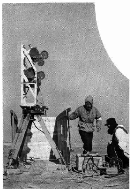
⇐ 発射瞬間標示用閃光電球取付作業 (中央) とランチャー直前のロケット弾道撮影用固定カメラ (左) 右端はランチャー
