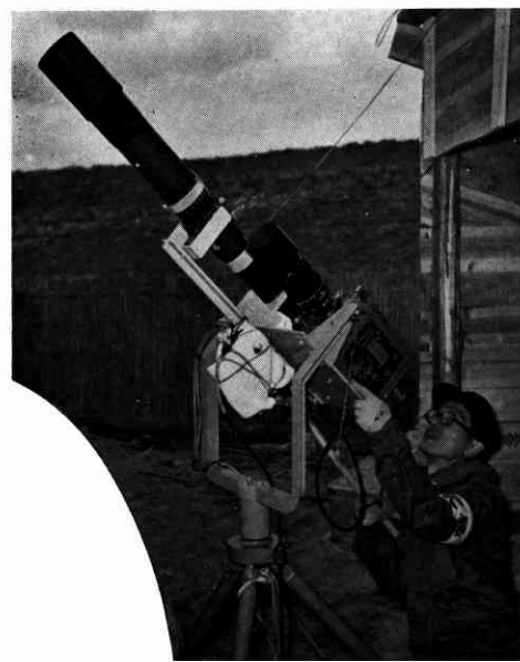
⇐ 追跡撮影用装置 (ランチャー南方 300m の高速度カメラ室)
