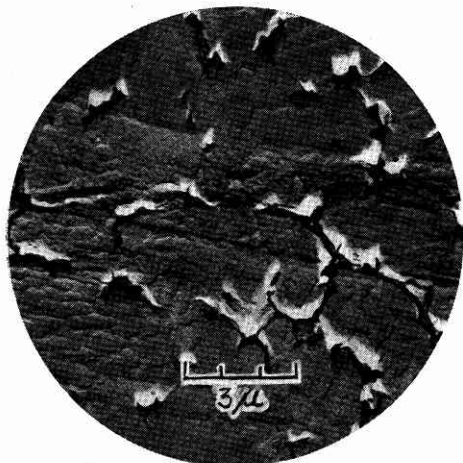
二段腐蝕を行った場合の rosette \beta' \times 5000 写真 9 (写真 4, 6 と同一試料)
