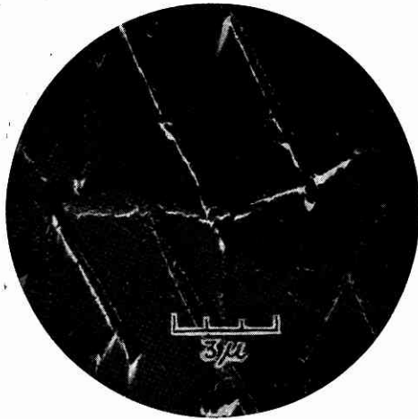
\beta' 中の \alpha の針状析出 \times 5000 写真 14 (写真 13 に同じ)
