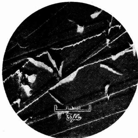
\beta' 中の \alpha の針状析出 \times 5000 写真 13 (写真 12 に同じ)
