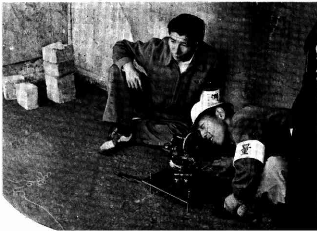
⇨ ランチャー（発射台）の設定方向に各ターゲットのセンターを正確に合わせるためにトランシットで毎回測定する。
