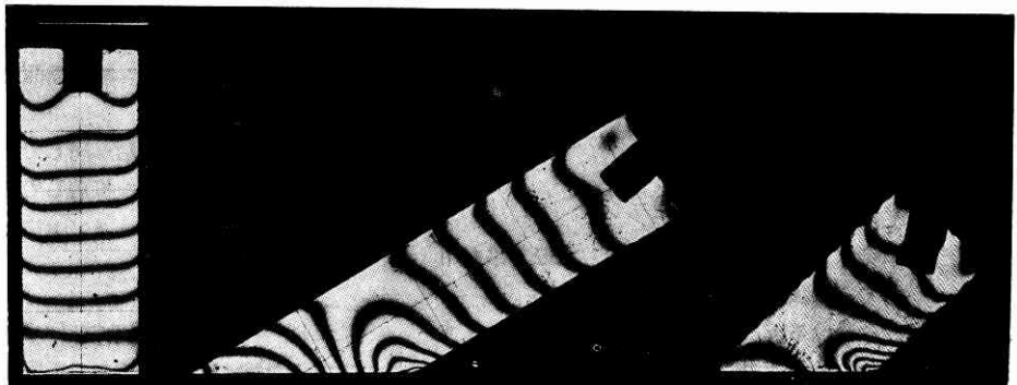
4-1 \theta=0^\circ 4-2 \theta=60^\circ , l 大 4-3 \theta=45^\circ , l 小 第4図 平行四辺形板の等色線図
