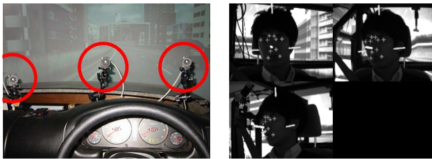
図 3.4: 頭部姿勢推定用カメラ（左）および頭部姿勢推定結果の一例（右）
