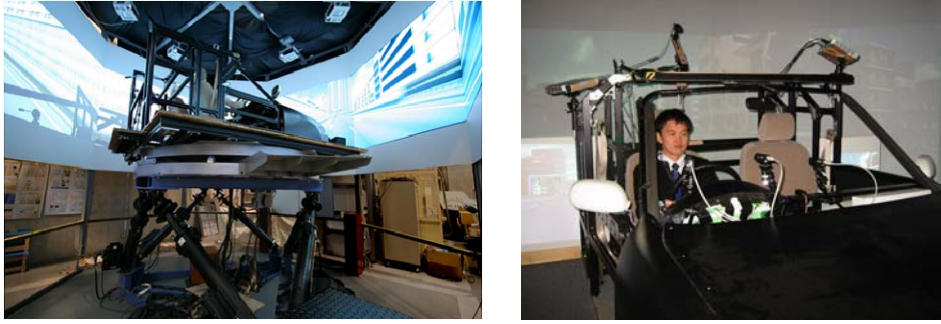
図 3.3: 実験に用いたドライビングシミュレータの外観
