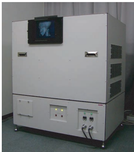
図 2.17: マルチプロジェクタを用いたインテグラルフォトグラフィシステム
