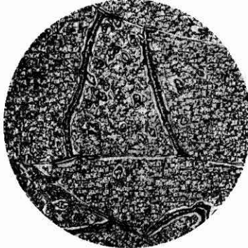
写真 2 500^{\circ}\text{C} 30秒 \times 130 (クロム酸電解腐蝕)
