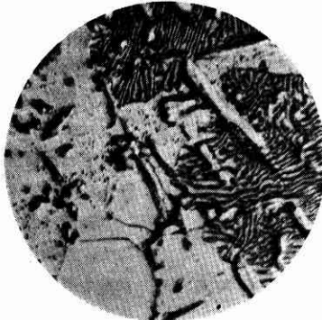
写真 5 450^{\circ}\text{C} 20分 \times 1100 (クロム酸電解腐蝕)
