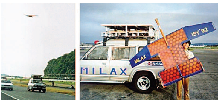
図 1.33 日本初の飛翔体へのマイクロ波電力伝送, MILAX(Microwave Lifted Airplane eXperiment), 1987 [39]
