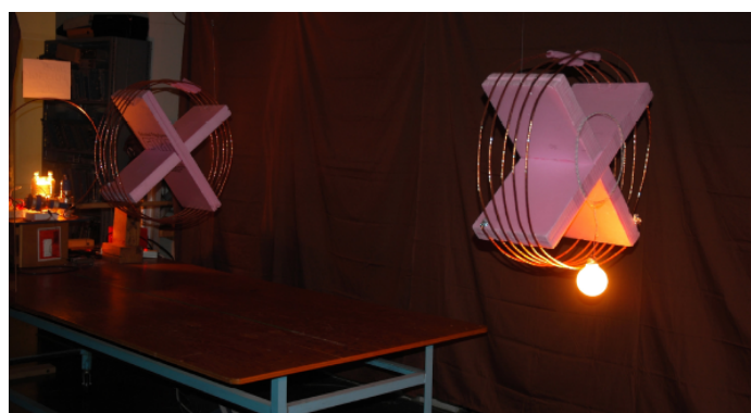
図 1.16 エアギャップ 2m において 60W 電力伝送した時の実験風景 [24]
