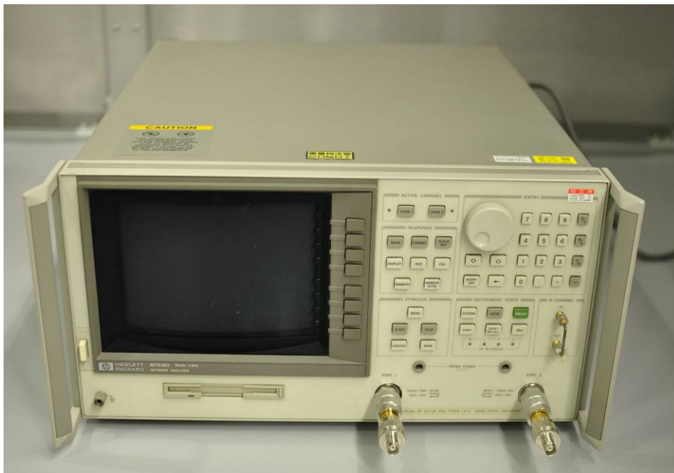
図 2.6 ベクトルネットワークアナライザ Hewlett Packard 8753D 30kHz～3GHz
