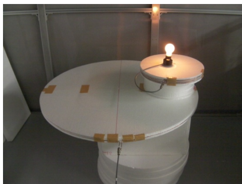
図 4.120 非対称アンテナの電球点灯実験（大円形）
