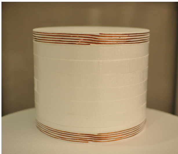
(a) ヘリカルアンテナ, 半径 150mm, 巻数 5 巻, 太さ 2mm (b) スパイラルアンテナ, 半径 150mm, 太さ 2mm
