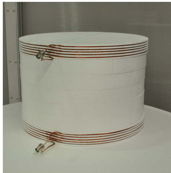
(d) ショートタイプヘリカルアンテナ（給電側）
