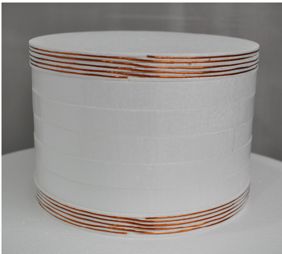
(a) オープンタイプヘリカルアンテナ（給電反対側）
