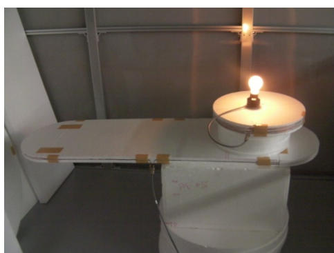
図 4.121 非対称アンテナの電球点灯実験（楕円形）
