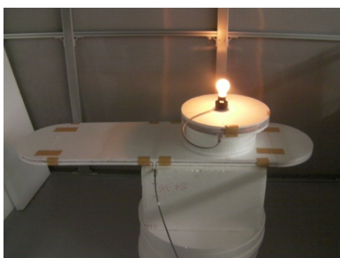
図 4.121 非対称アンテナの電球点灯実験（楕円形）
