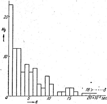
第 1 図：破断の時間おくれの分布(平田)
