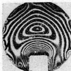
第11圖 キー溝のある丸棒のねじり應力の分布——キー溝の底部に應力の集中があることが解る。
