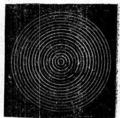
第5圖 同心圓群の光源: 寫眞の乾板に黒地に白の同心圓群をえがいたもの。
