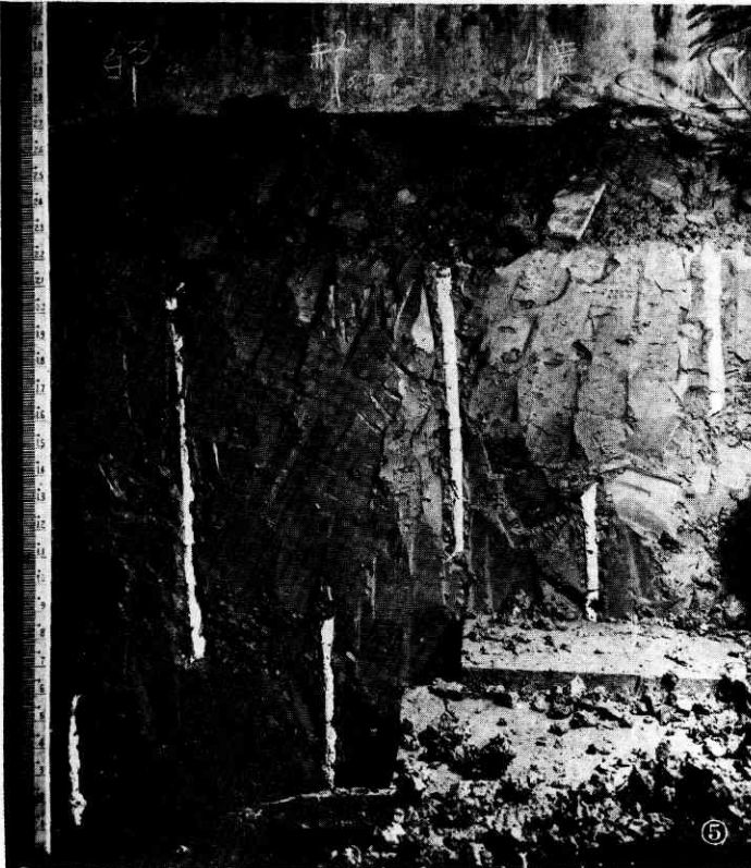
⑤ あらかじめ垂直に作つた石灰棒の剪断移動からとらえた見事な断面
