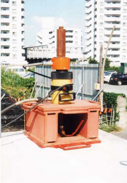
写真 3-7 プレロード・鉛直荷重装置
