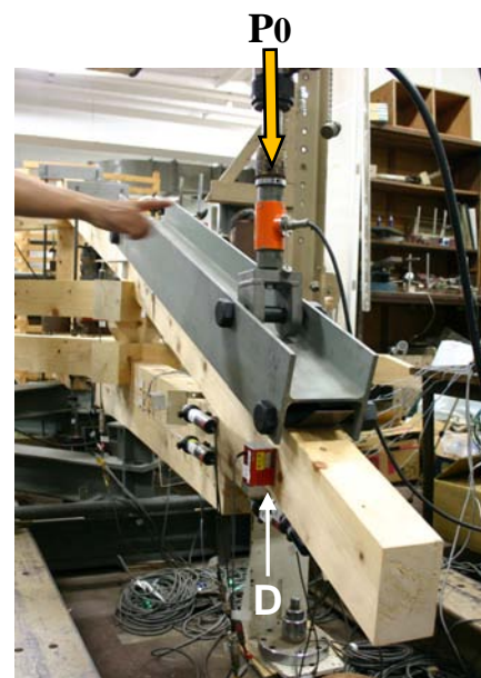
図2-10 尾垂木先端 加力治具
