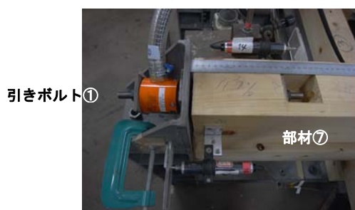
図2-9 引きボルト① 設置状況
