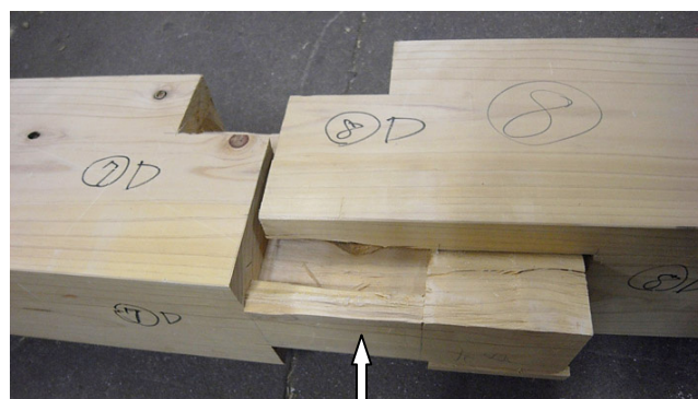
せん断破壊して鎌継内に残った女木部分
