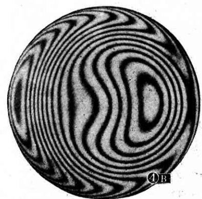
④ 干渉縞の曲線に現れた不良レンズ (A) 脈理があるため使用できないレンズ (B) 脈理はないが收差がはなはだしいレンズ
