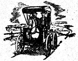
第6圖 Uriah Smith の自動車(アメリカ, ミシガン州)馬首の模型は通行する馬を驚かさぬため。
