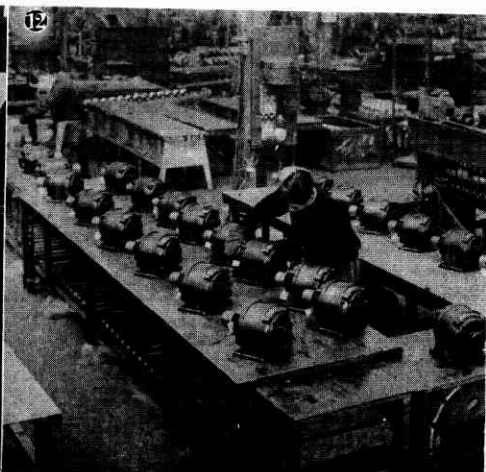
⑫ スラット・コンベアの接續部におけるモーターの回転試験状況
