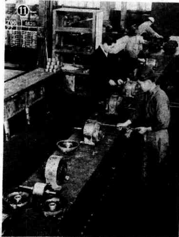
⑪ スラット・コンベア上のモーター産立作業（コンベア速度 230 mm/mn）
