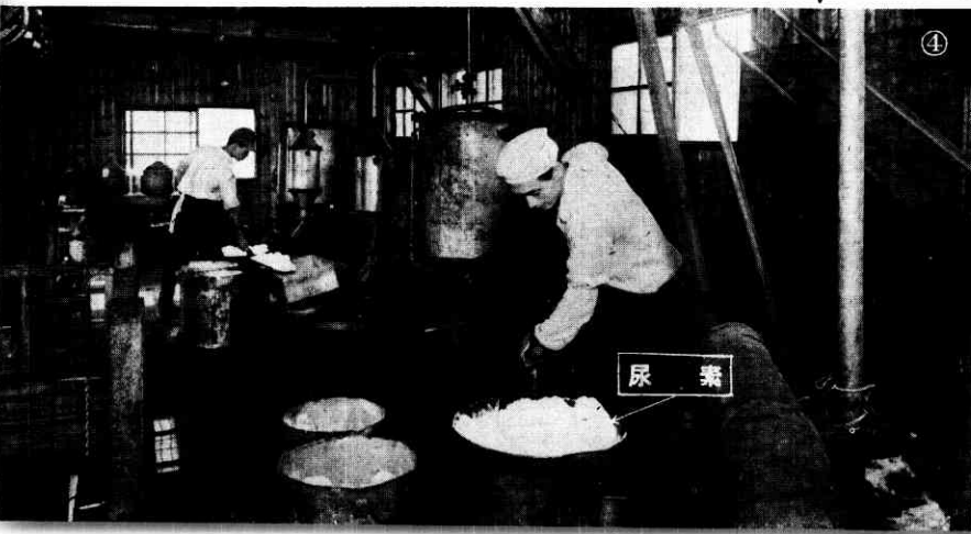
④ 尿素樹脂合成装置 1モルの尿素に対し2モル以上のフォルマリンおよび觸媒としてアンモニア等を添加し 100°C 附近で加熱し反応させる。
