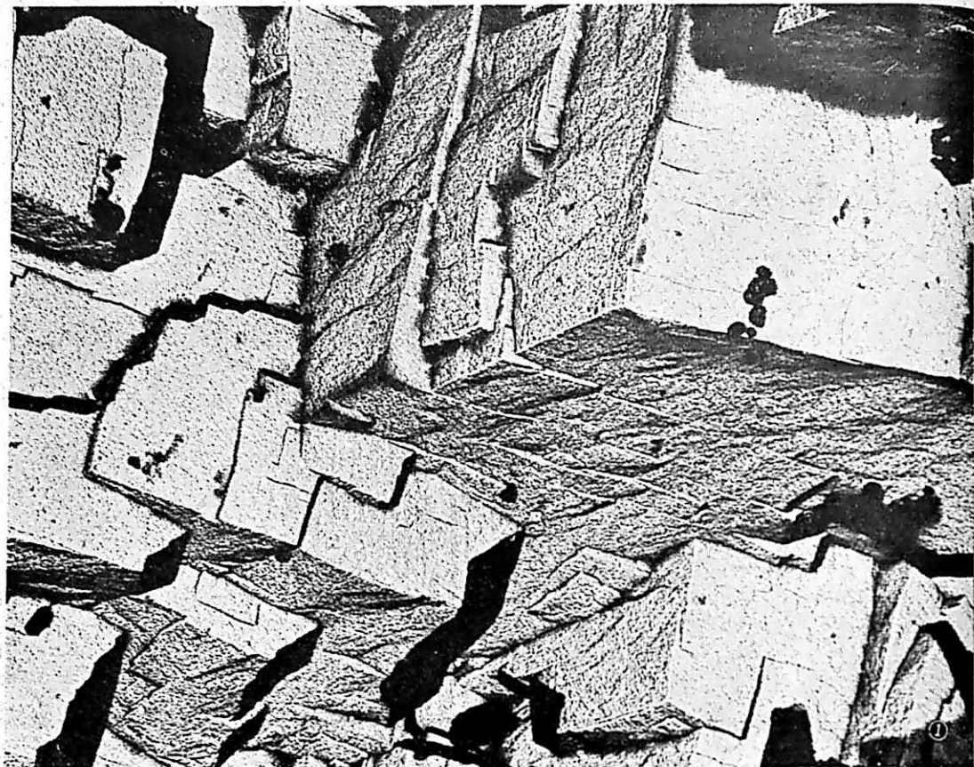
純アルミニウム単結晶腐蝕面 (日本電子光學株式会社提供)
