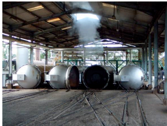
写真 2-4 タイ・スラタニ市近郊のパームオイルミルの加圧滅菌器(筆者撮影)
