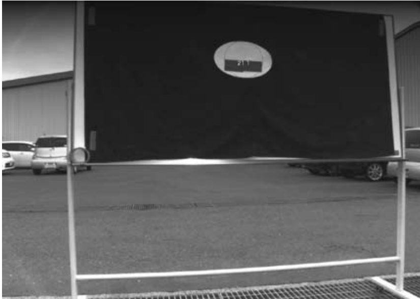
写真-7 ホワイトボード上での楕円の測定 Photo 7. Measurement of area of ellipse on whiteboard
