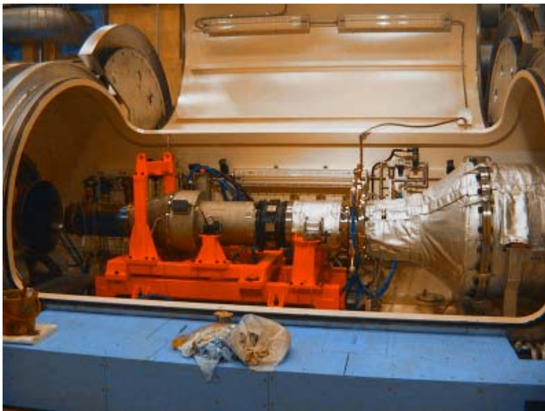
図3.3-4 超音速エンジン試験セットアップ
