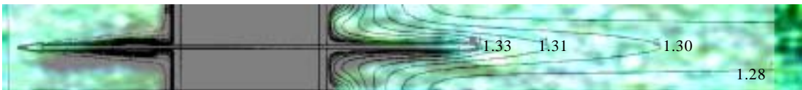
図3.2-10 密度分布 (シュリーレンによる可視化結果と数値解析結果)
