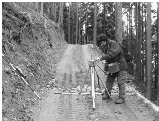
図-9 CASPOLによる測定状況 Fig. 9. Photo of testing by CASPOL
