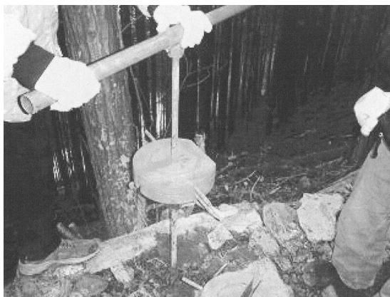
図-12 スエーデン式サウンディング試験状況 Fig. 12. Photo of testing by Sweden typed sounding tester
