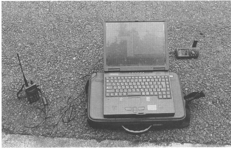
図-4 無線を用いた GPS データ通信システム
