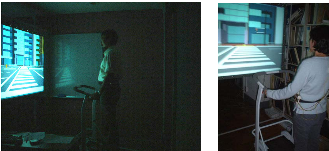
図5-3 トレッドミル式歩行シミュレータによる実験の様子
