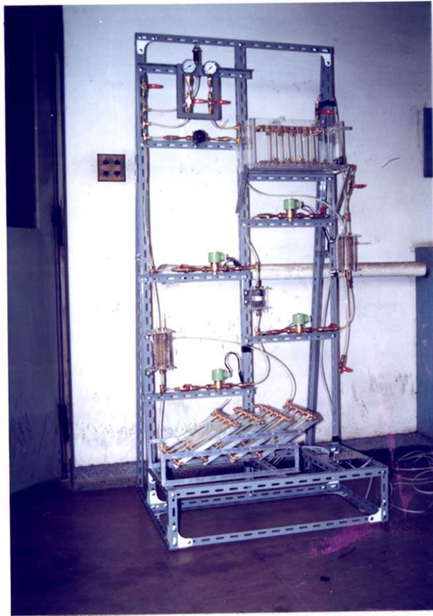
図 5-2 自然循環式太陽熱ポンプ実験用模型
