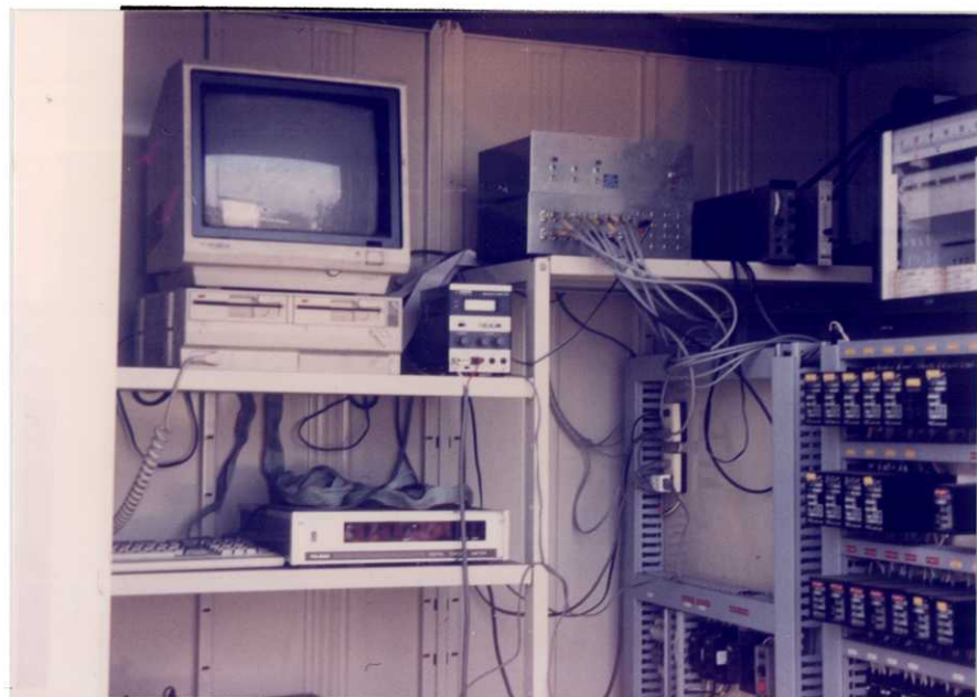
図 5-12 自然循環式太陽熱ポンプ計測制御装置
