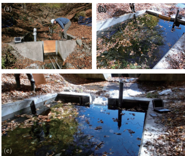
図-6. プールを利用して水位-流量関係を求める方法。(a)(b)ノッチの内側に板をあてて堰堤内に水をためる。(c)板をはずして水位変化を1秒間隔で記録する。
