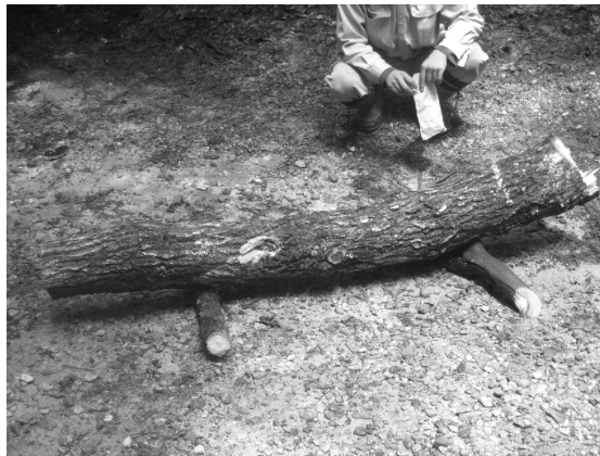
写真－２．切断した長さ150 cmの丸太（北側の地際から70 cmから220 cmの高さ） Photo.2. The 150-cm-long log excised at heights of 70 cm and 220 cm above the ground.
