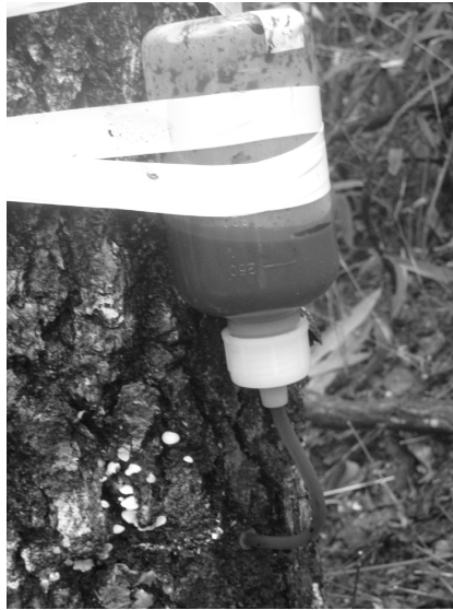
写真－１．対象木に取り付けた染色液注入器
