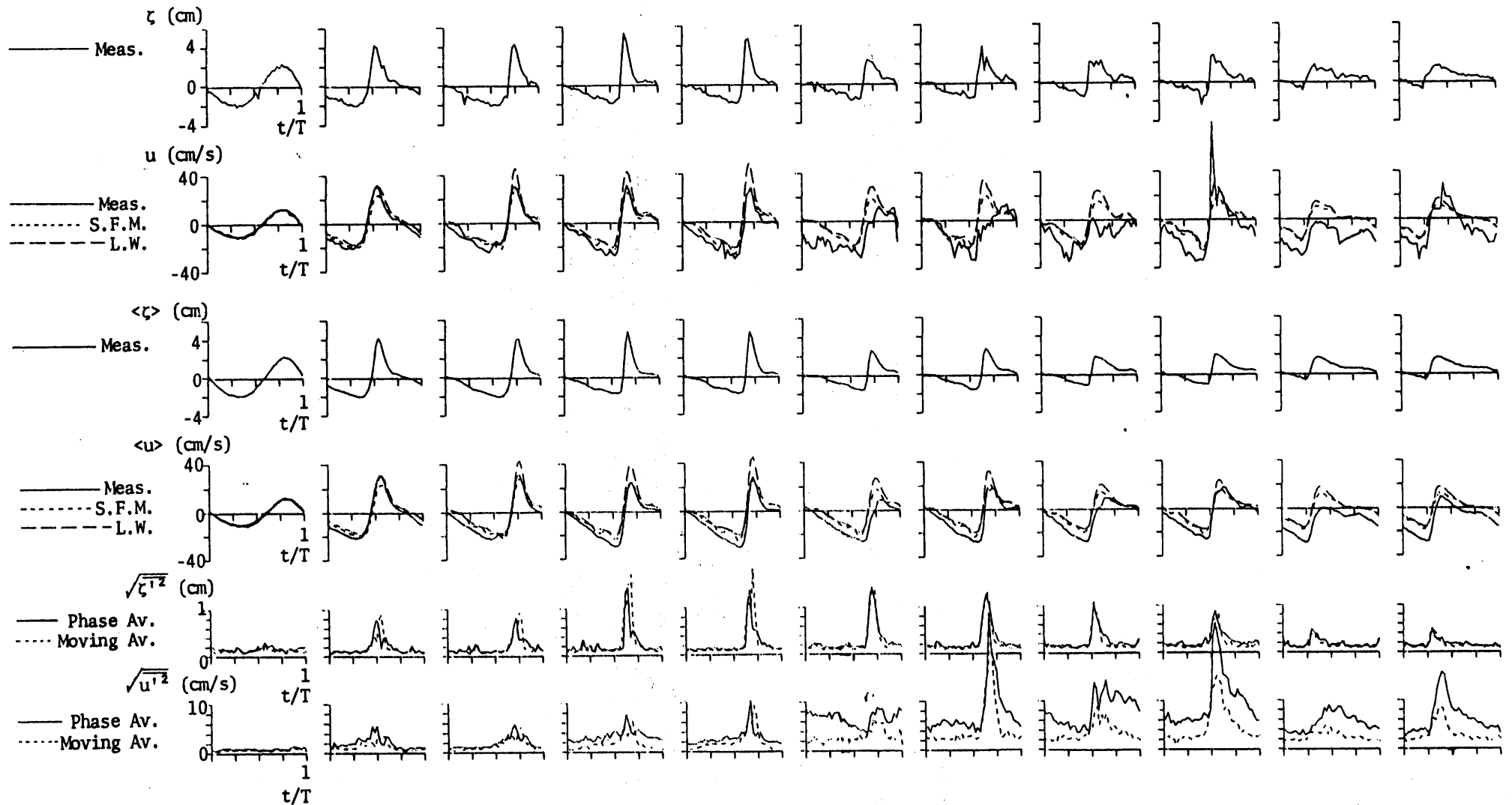
図-3.2.5(a) 水面変動・岸沖方向流速・乱流の測定結果および岸沖方向流速の計算値
