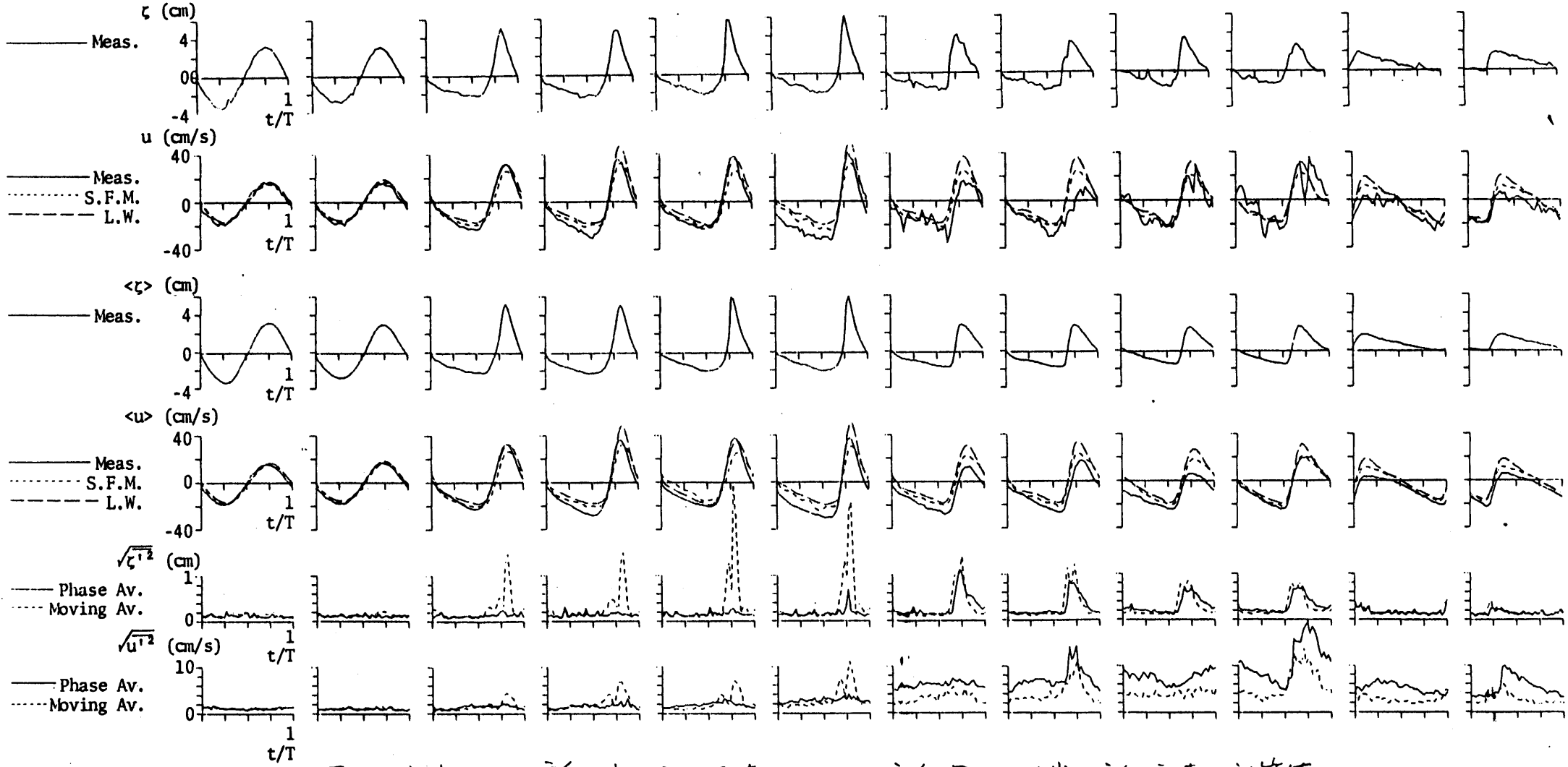
図-3.2.5 (b) 水面変動・岸沖方向流速・乱流の測定結果および岸沖方向流速の計算値
