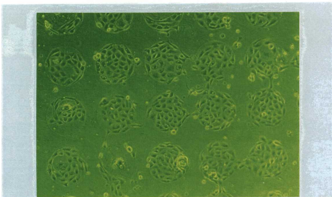
図 5-16 イオンビーム照射したPP表面への細胞接着挙動
