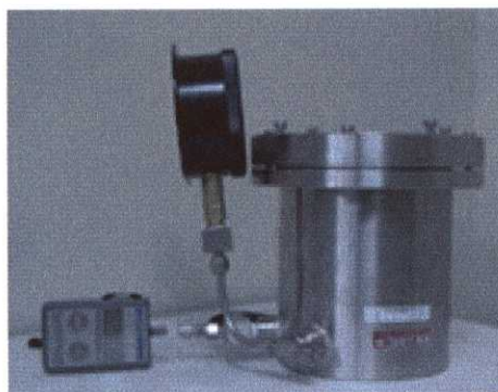
図 2-2 耐圧容器とプレッシャーモニタ
