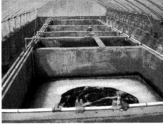
写真2 榆林学院に導入された糞尿処理装置
