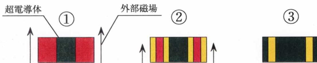
(b) 磁束が超電導体中心部まで十分侵入しないモデル
