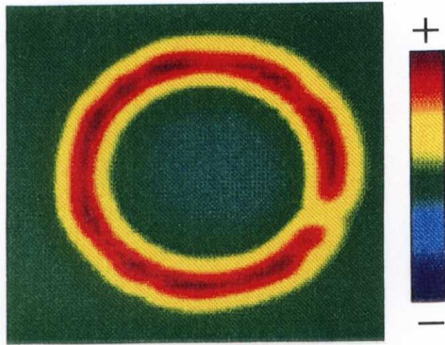
Fig.5.36 パルス磁場印加後の残留磁束密度
