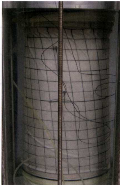
4: \gamma = 11\% 剛性回復後の除荷時の様子。供試体上部端面の変形局所化が大きくなる。ベDESTAL 付近のしわも大きくなる。
