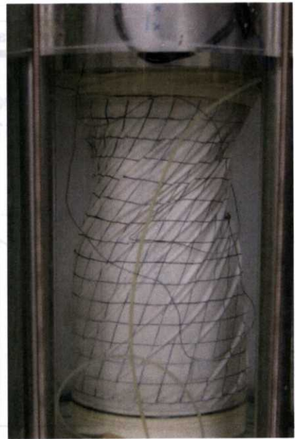
5: \gamma = -43\% 逆振りの除荷後の様子。供試体上部に深いしわが入り、収縮する。しわが入る瞬間はセル水が波立つほどの振動
