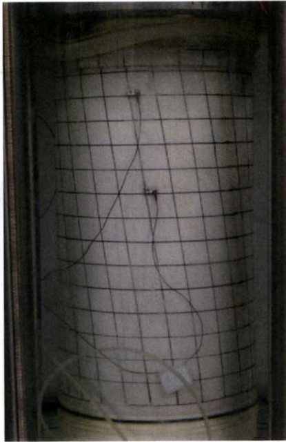
1: \gamma = 10\% 供試体の変形は概ね一様。
