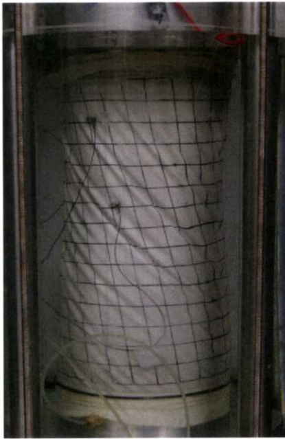
3: \gamma = 19\% 2の除荷後の様子。供試体全体に大きなしわが約 45^\circ に入り、供試体上部が若干収縮。
