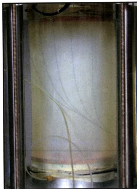
写真6.3.1 メンブレン張力補正試験に用いた水+メンブレン供試体
