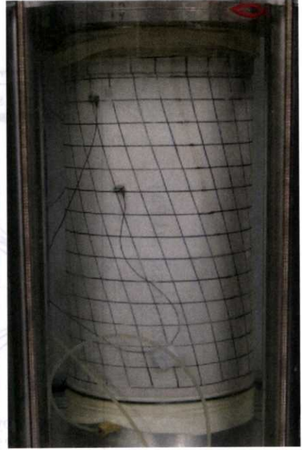
2: \gamma = 20\% 供試体の変形はS字型を呈する。中心部の変形は概ね一様。
