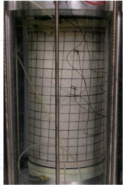
2: \gamma = -4\% 1 の逆振りの様子。供試体の変形は概ね一様であるが、若干 S 字型となる。
