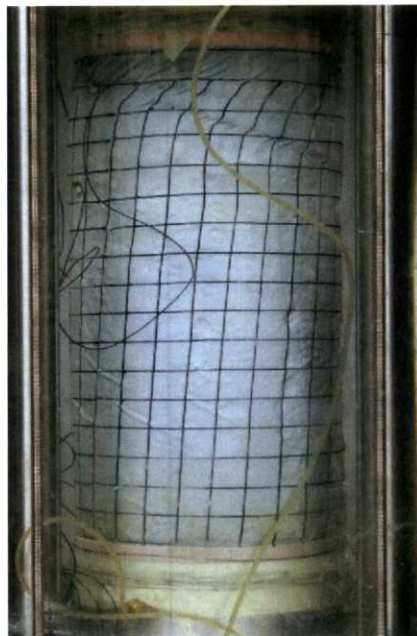
3: \gamma = -14\% 上端部に変形が集中。上部にせん断層が入る。中部から下部にかけてしわが発生。
