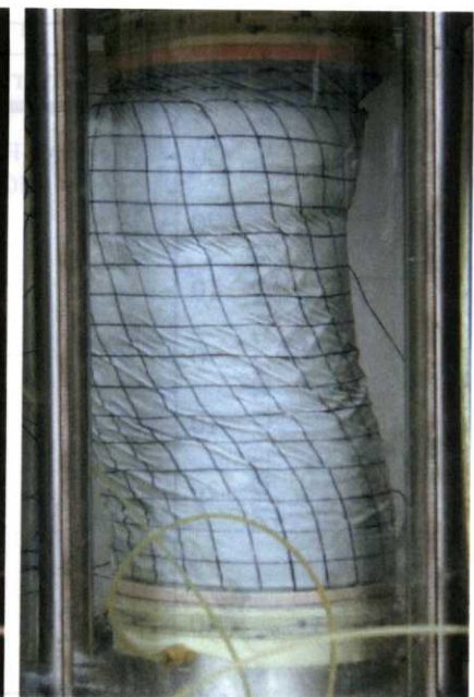
5: \gamma = 40\% 供試体大きく歪む。変形は上端部に集中し、中央上部にせん断層発達、局所化。中央下部一定幅にしわが多くある。
