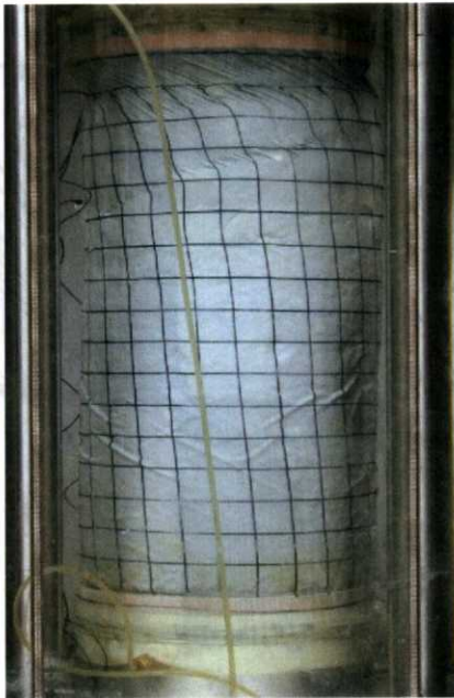
4: \gamma = 20\% 供試体は歪む。上部に3と逆方向の大きなせん断層が認められる。中部から下部にかけてしわが×印を形成。
