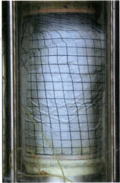
5: \gamma = 45\% 供試体大きく歪む。変形は上端部に集中。上部にせん断層が数本ある。中央下部にしわが多くあり、4より明瞭。
