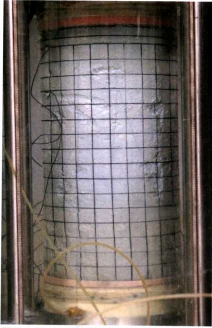
液状化試験前 原位置凍結採取試料 (洪積層)
