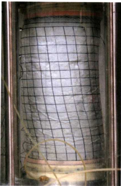
3: \gamma = 15\% 供試体がねじれ、歪んでいる。中部から下部にかけてしわが発生。上端部に変形が集中する。
