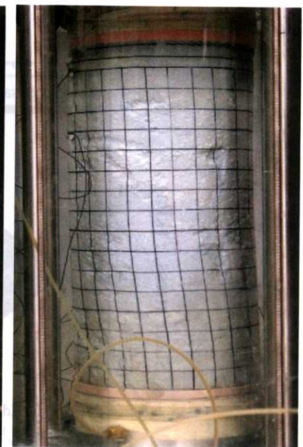
2: \gamma = 7\% 供試体下部の変形が大きくなる。くの字型の変形。
