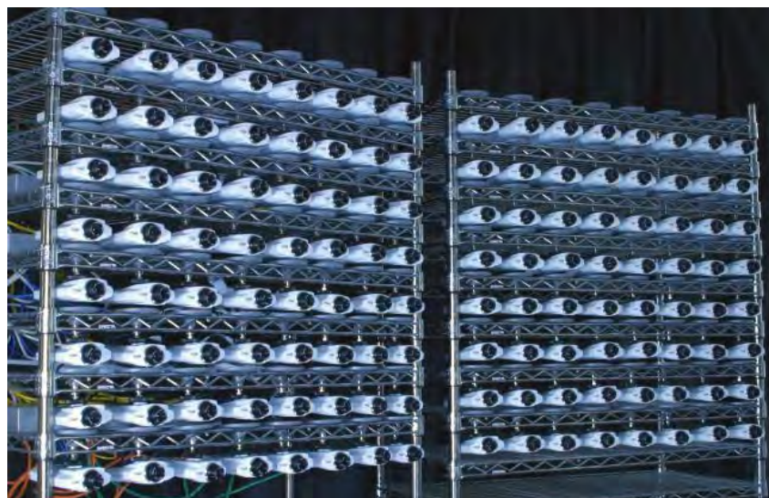
図 7.12: 本研究室において開発しているカメラアレイ。
