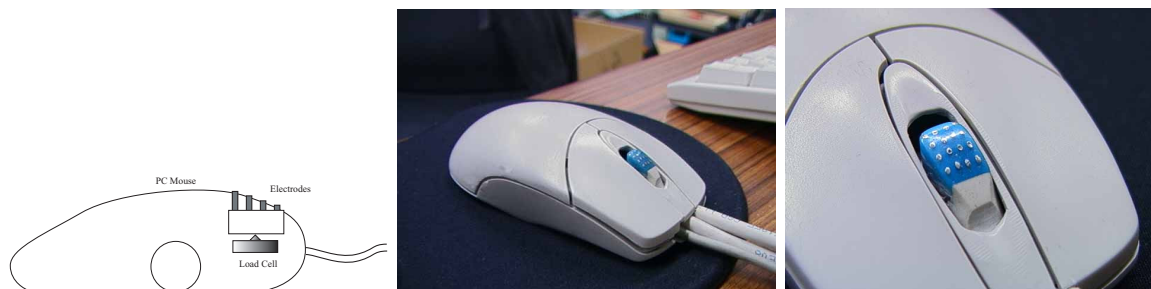
図 5.9 カセンサを内蔵した電気触覚マウス (左) 断面図 (中) 全体図 (右) 電極部拡大 .
