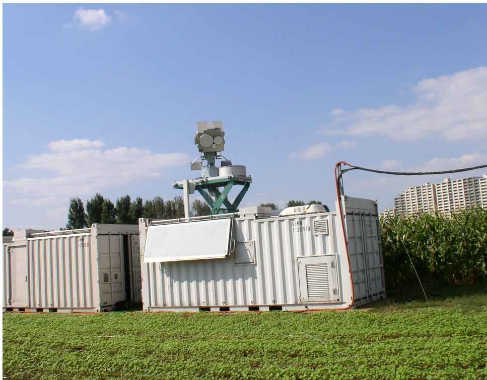
図 4.1: 地上可搬型マイクロ波放射計観測システム
