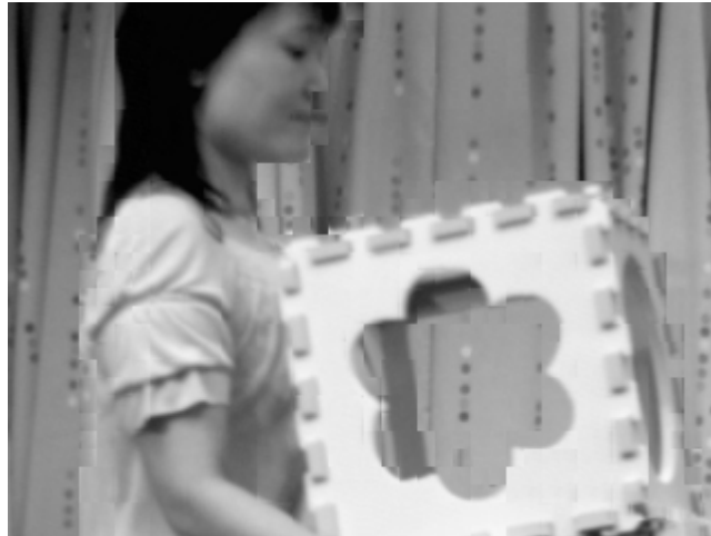
図 6-12 16x16pel/8x8pel 可変ブロックサイズ予測結果 (PSNR=33.05dB)
