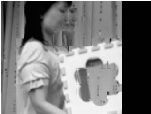
図 6-10 ブロックサイズ 16x16pel での片方向予測結果 (PSNR=10.66dB)
