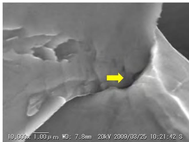
Fig.3-52 Fig.3-49 (B) に見られた破壊起点
