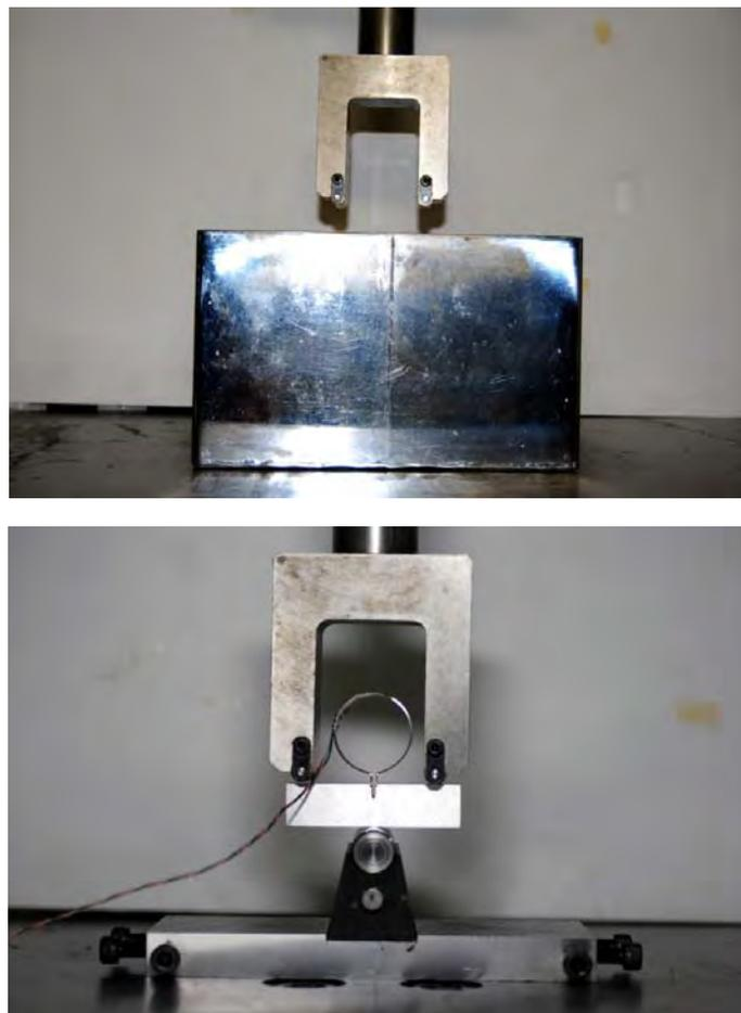
Fig.3-44 切欠き付 3 点曲げ試験の外観
