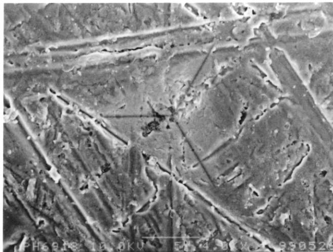
図 3-29 くぼみのSEM写真 (算術平均粗さ Ra : 0.103 \mu m, 押込み荷重 : 10gf)
